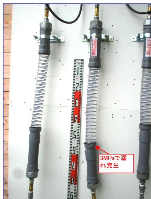
3MPa加圧で中央の350mmが600mmまで伸長し 漏れ発生 2.5MPaまで漏水、異状なし
