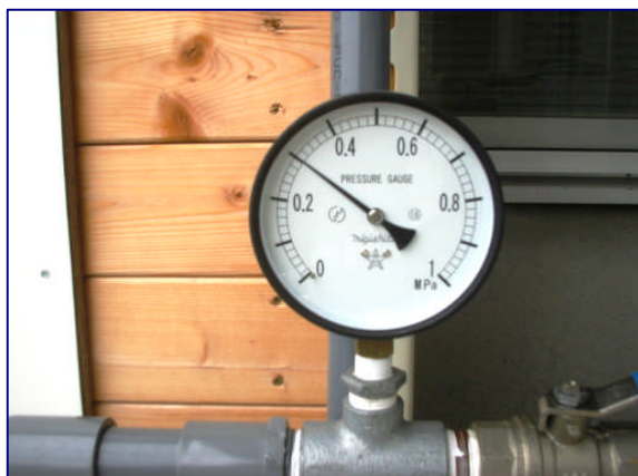
3MPa加圧で中央の350mmが600mmまで伸長し 漏れ発生 2.5MPaまで漏水、異状なし
