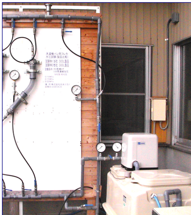
45度曲げの状態で水圧をかけます。
