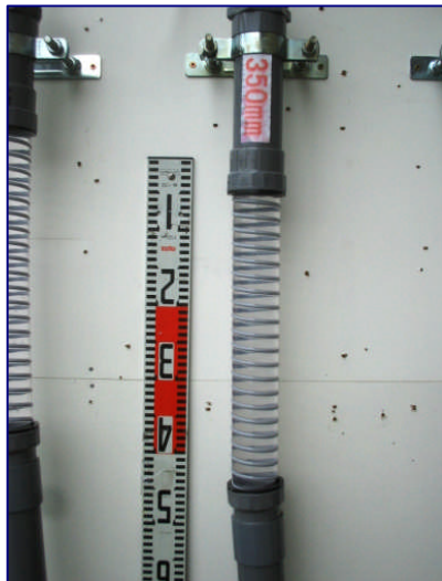
水圧試験 試験体は右から300L、350L、400L
