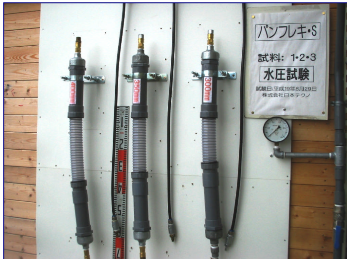
水圧試験 試験体は右から300L、350L、400L
