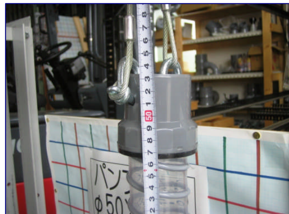
全長300mmが530mmに伸長 ソケット部異状なし
