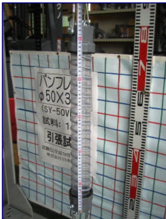
全長300mmが530mmに伸長 ソケット部異状なし
